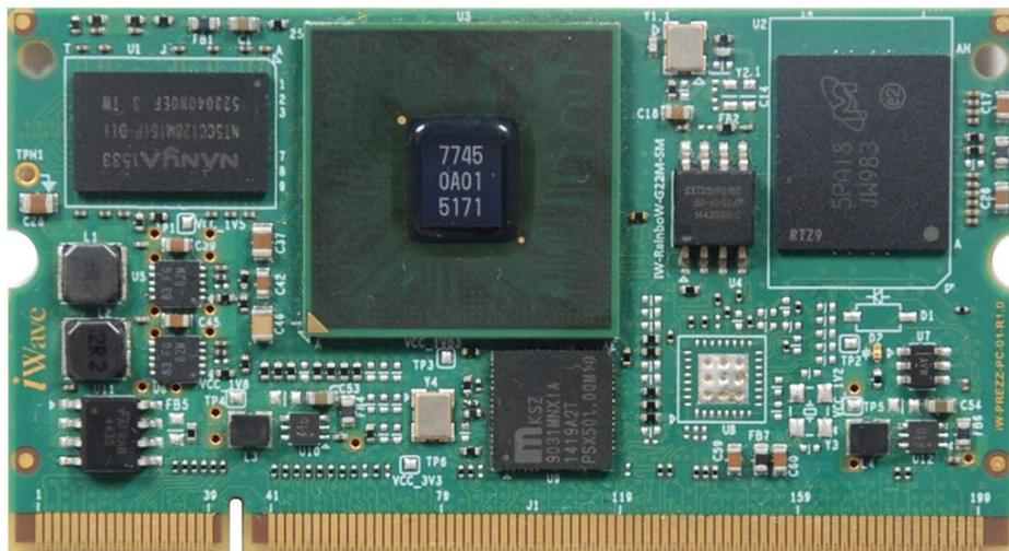
また、迅速な試作品の開発やタイムリーなマーケットへの製品投入が可能となるように、100mm x 72mm Pico ITX 規格のキャリアボードと SOM で構成された開発キットを提供します。キャリアボードは SOM との組み合わせで量産にも対応可能であり、RZ/G1E の MPU の機能をすべて評価可能なコネクタを搭載しています。
